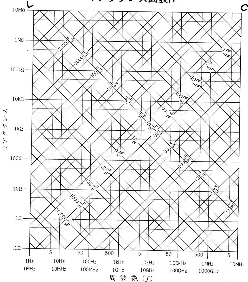
この図表は、インダクタンス(コイル)の誘導リアクタンス( $\omega L$ )とコンデンサの容量リアクタンス( $1/\omega C$ )を求める図表である。
